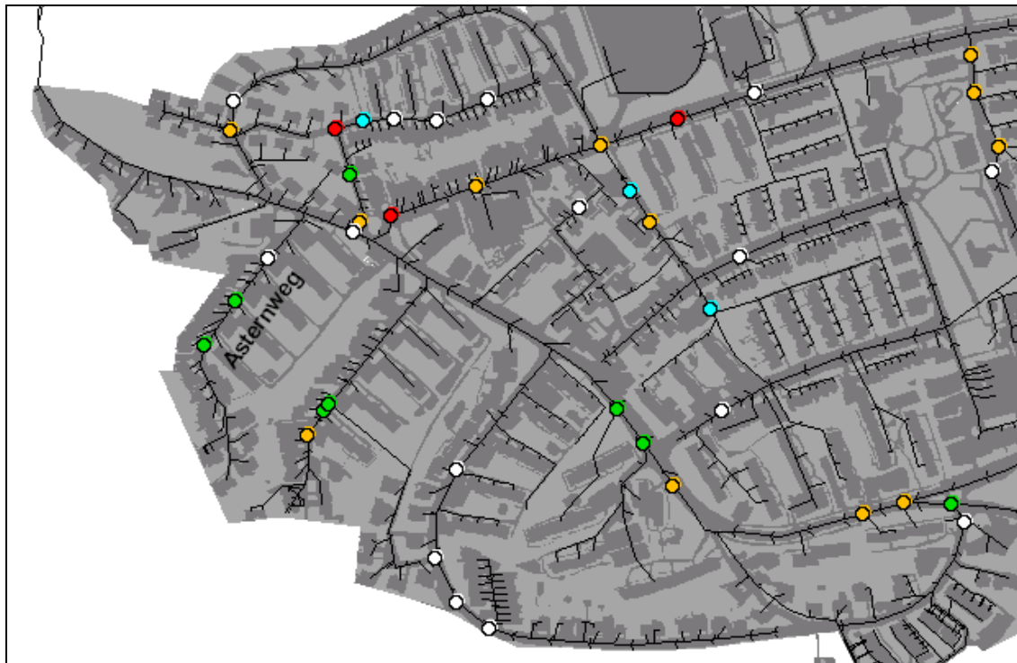
Abbildung 3-6: Überstauverhalten nach Umsetzung der Maßnahmen M1 bis M4 im Bereich Asternweg (Fall Klimawandel + 20 %)
