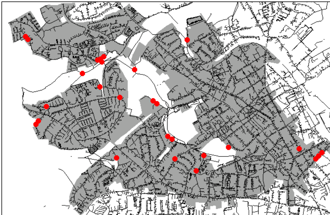
Abbildung 3-1: GEP Abtsküche: Zusätzliche Überstauschächte „Klimawandel +10 %“ (ohne Maßstab)
